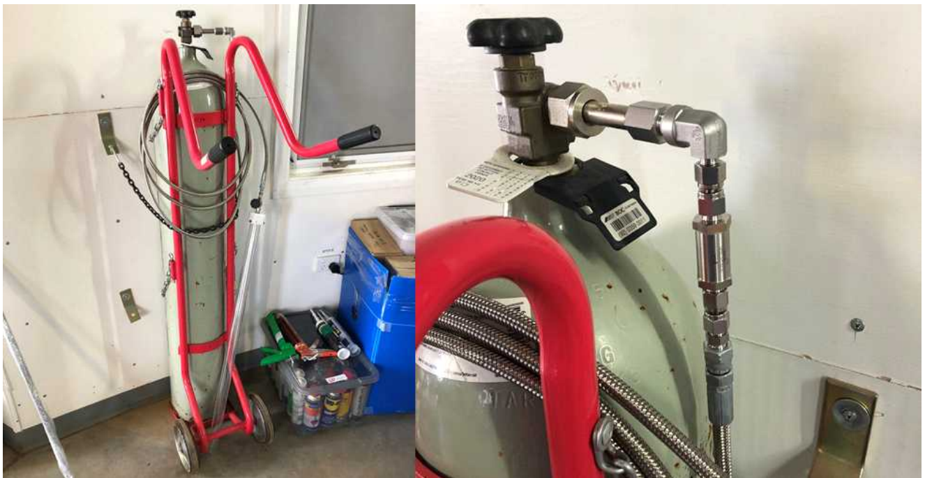
그림 16. 주경 청소를 위한 스노우건 피팅 교체 및 고정
