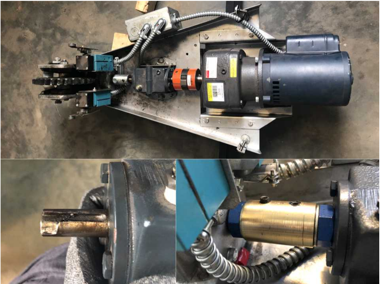
그림 8. 동력부와 돔 드라이브 기어와의 커플링 파손으로 인해 발생한 샤프트 유격 및 교체품
