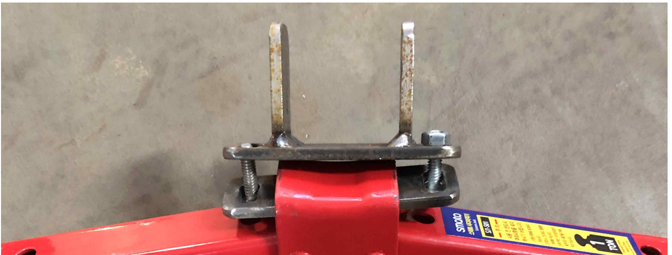
그림 3. AUSBOX에서 디자인 및 제작한 상단셔터 고정 구조물
