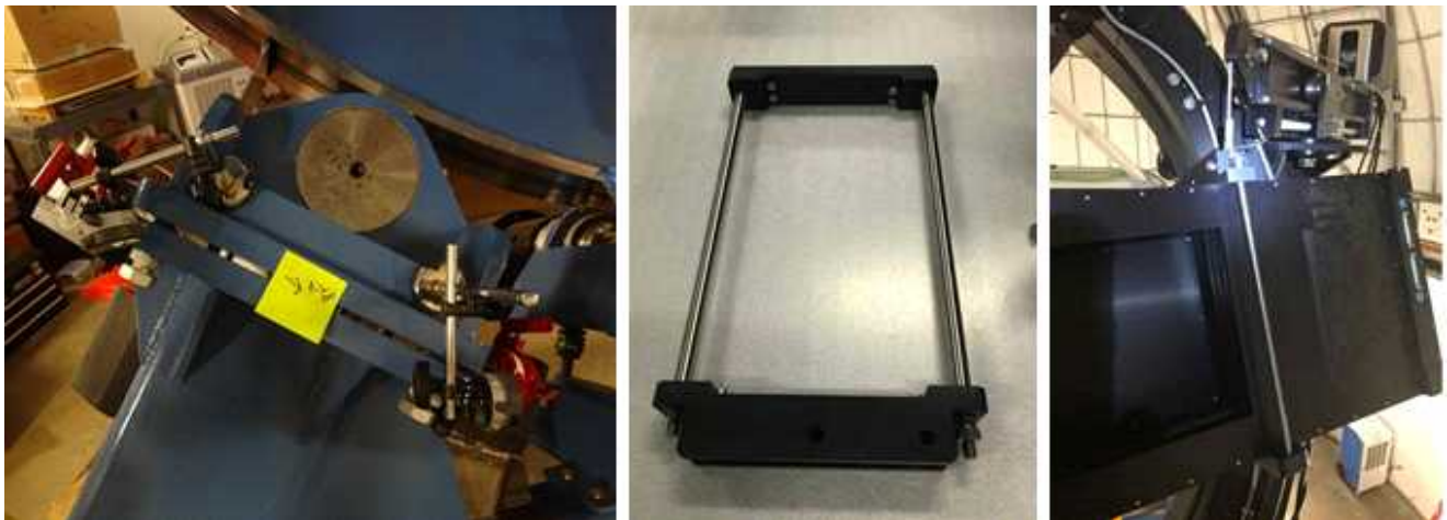
그림 6. RA 디스크 정렬 장치(좌), FSA의 1인 설치를 위해 새롭게 디자인하여 제작한 고정 홀더 및 설치작업(중앙, 우)
