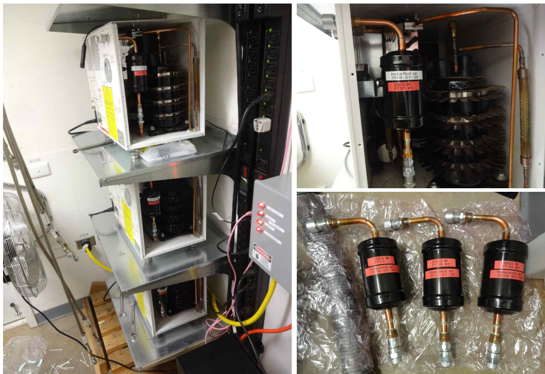
그림 8. 카메라 듀어 냉각기 컴프레서 internal adsorber 교체작업
