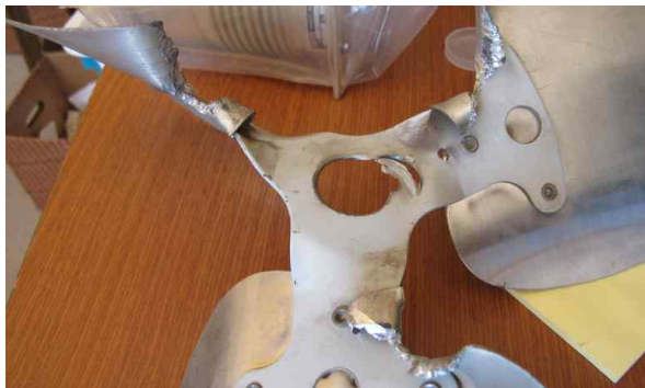
교체 전 (Fan 파손)
