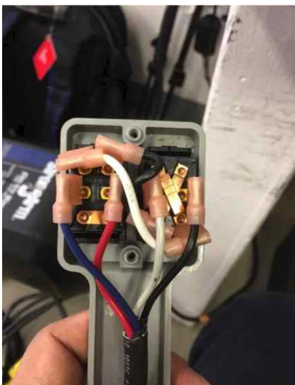
그림 9. 무선 조종 장치를 사용하기 위한 릴레이 배선과 실제 장치에 적용하여 테스트하는 모습
