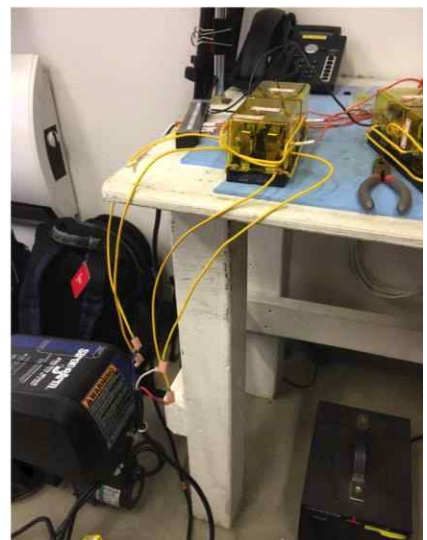
그림 9. 무선 조종 장치를 사용하기 위한 릴레이 배선과 실제 장치에 적용하여 테스트하는 모습
