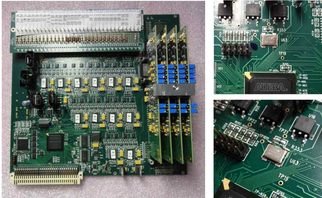
그림 14.CCD 카메라 전자부의 CBB 회로 디버깅 - oscillator pin 연결
