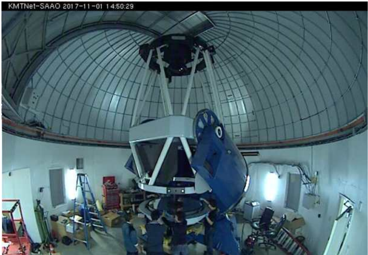
그림 1. 미러셀을 분리하고 배플을 설치하는 장면(돔 내부영상에서 캡처)
