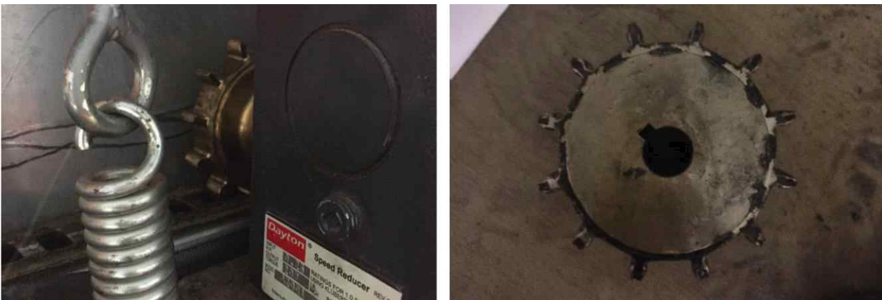
그림 6. 기어리듀서를 교체하기 전의 돔 회전 기계부 모습과 리듀서 교체를 위해 스프라켓을 제거한 모습. 스프라켓의 톱니가 매우 얇아진 것을 볼 수 있으며 이는 돔이 갑자기 회전을 시작할 때와 멈출 때 레일과의 마찰에 의해 기어가 닳아서 발생한다. 근본적 해결을 위해 소프트 드라이빙 장치를 추가할 예정이다.
