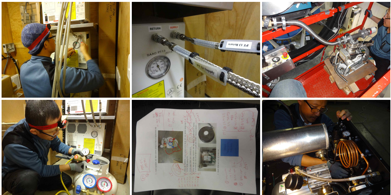
그림 27. 카메라 장비 유지보수 작업 및 상주관측자 연수. 왼쪽 위부터 가스리버싱, 듀어 진공펌핑, 콤프레셔 냉매가스 충전, 냉매가스 충전 매뉴얼, 건조공기생성기 유지보수 작업의 모습이다.
