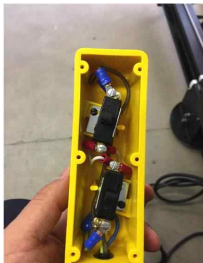
그림 9. 무선 조종 장치를 사용하기 위한 릴레이 배선과 실제 장치에 적용하여 테스트하는 모습
