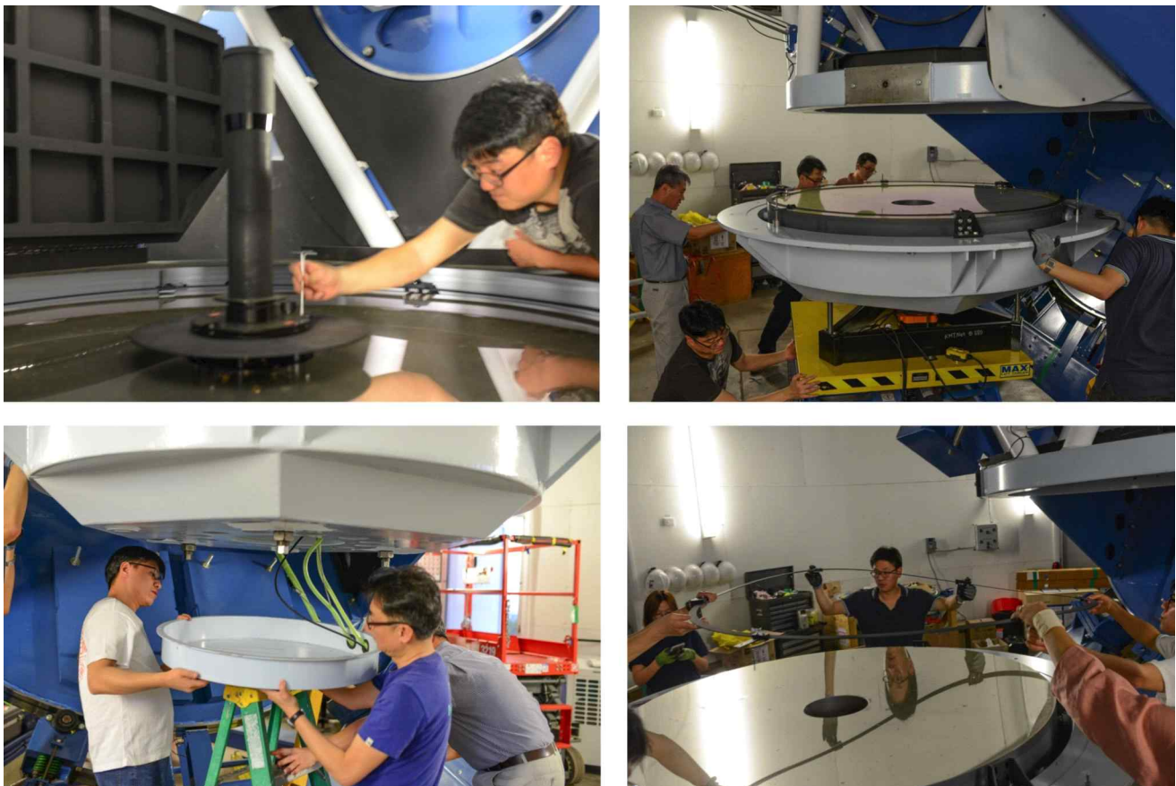
그림 1. 망원경 경통에서 미러셀을 분리하기 위해 모자이크 CCD 카메라 빔프로젝터와 냉각팬을 제거하고 주경배플을 분리하는 과정
