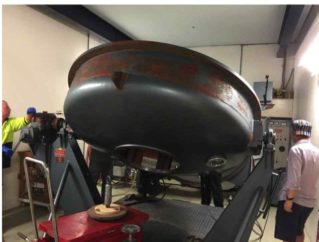
그림 7. 클리닝을 마친 주경을 진공챔버에 설치하는 과정과 이온브러쉬를 이용한 먼지제거 과정
