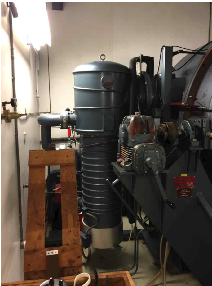
그림 8. diffusion 펌프를 이용한 진공 펌핑과 알루미늄 evaporation 장면
