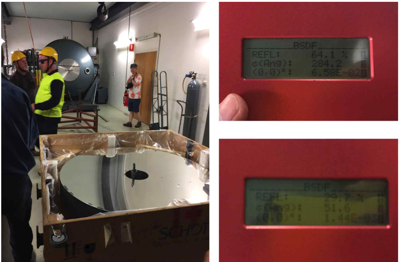
그림 4. UKST 건물로 이동한 주경과 측정된 거울 반사도
