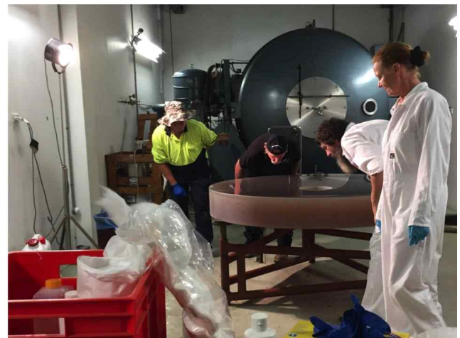
그림 6. BALZERS cleaners를 이용한 최종 클리닝 및 진공 챔버에 넣기 전 육안검사과정
