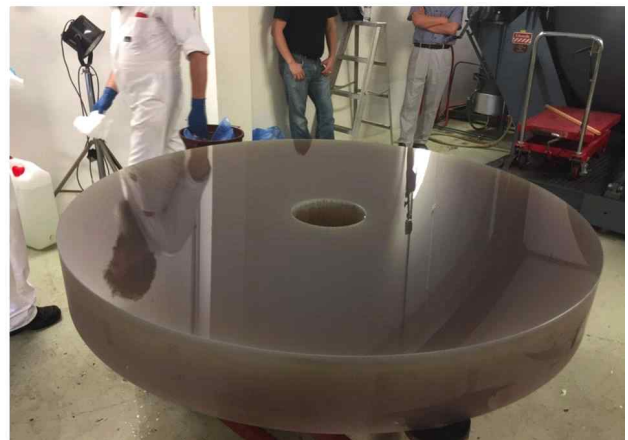
그림 5. Photo-Flo 200을 이용한 주경 린스 및 CR-7용액을 이용하여 크롬층을 제거하는 과정
