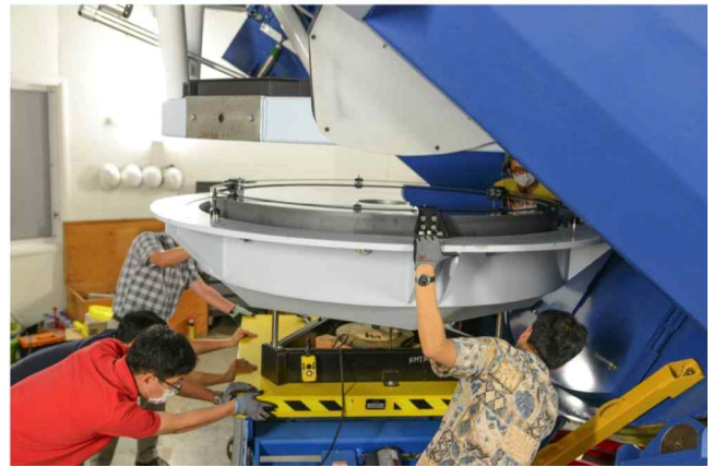
그림 12. KMTNet 돔내에 설치된 체인블럭을 이용하여 미러셀을 미러에 설치하는 과정
