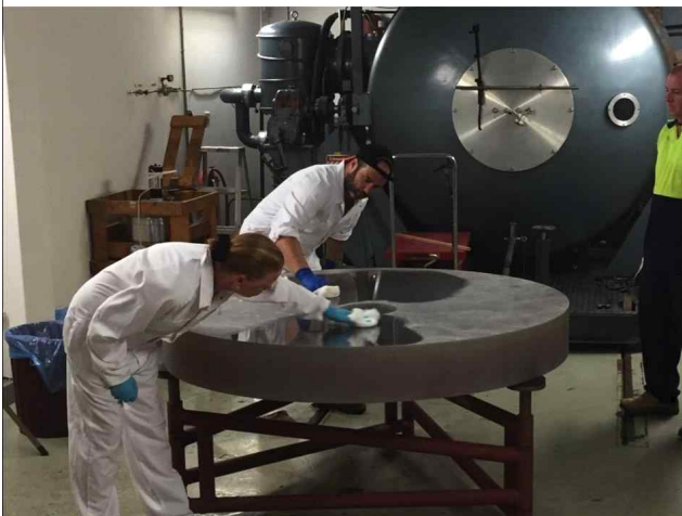
그림 6. BALZERS cleaners를 이용한 최종 클리닝 및 진공 챔버에 넣기 전 육안검사과정
