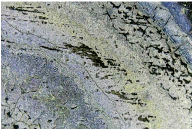
그림 2. 손상된 거울 코팅면의 500배 확대사진. 경면에 떨어진 물방울 및 이물질로 인하여 protected silver 코팅면의 보호막이 손상된 것으로 여겨진다.
