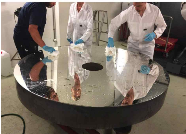
그림 5. Photo-Flo 200을 이용한 주경 린스 및 CR-7용액을 이용하여 크롬층을 제거하는 과정
