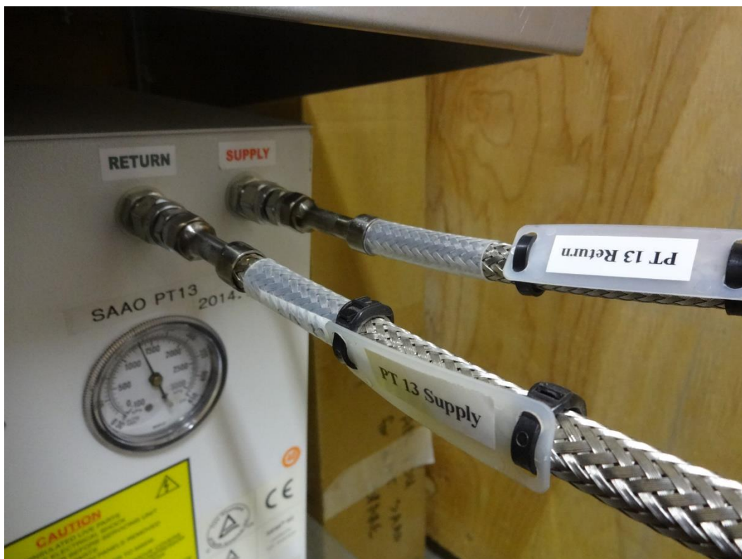
<컴프레서의 Return/Supply 리버싱 모습>
