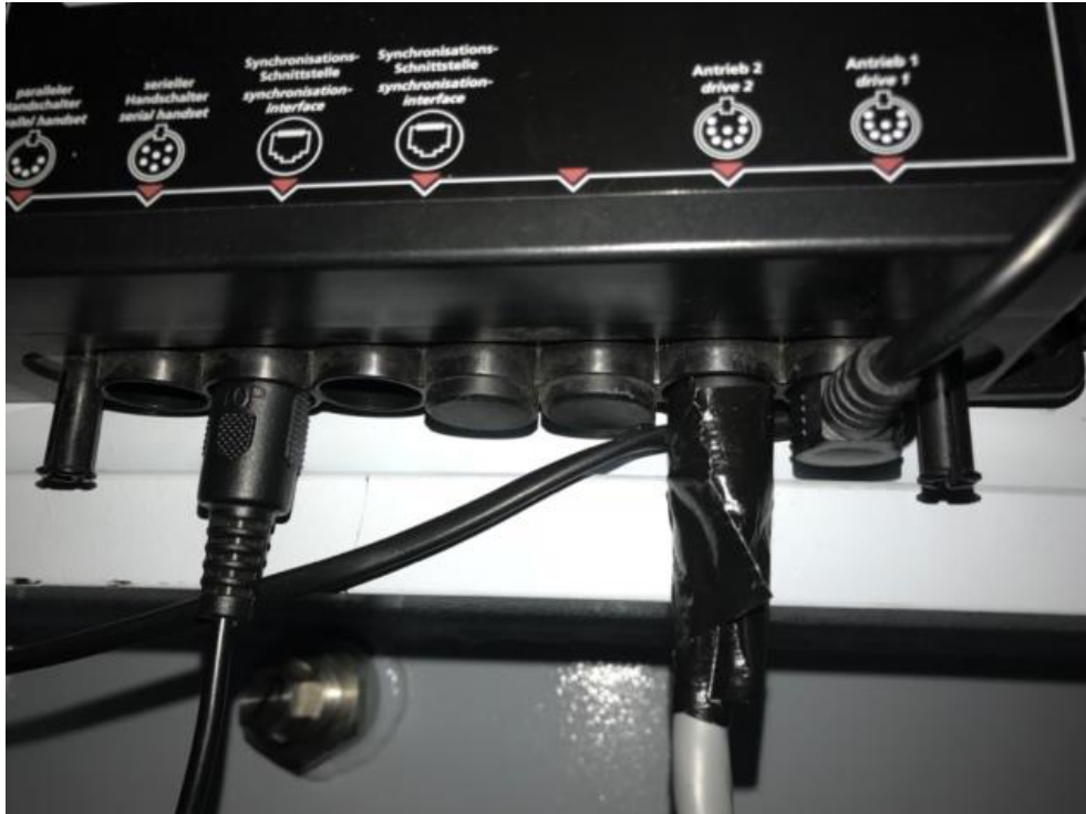
Figure 3 주경 커버 액추에이터 컨트롤러에 연결된 케이블. 좌측부터 시리얼 통신 케이블, 액추에이터 2번 전원 및 제어 케이블, 액추에이터 1번 전원 및 제어 케이블
